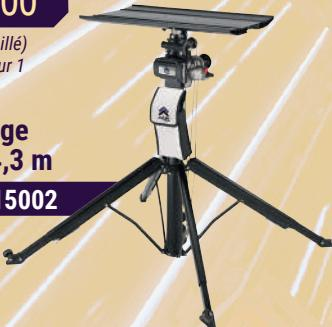
Lève-charges électriques avec grande stabilité (4 pieds réglables) et plateau rotatif 360° avec blocage multi-positions. Actionnement : électrique 230 V, manuel ou perceuse batterie (non fournie). Limiteur de charge intégré. Hauteurs max : 4,30 m ou 4,90 m selon modèle.
